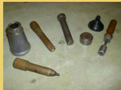
Da sinistra: pistone e campana per far saltare le capsule inesplose; cilindro in legno e cilindro metallico per ridare forma alla cartuccia e compattare la polvere da sparo; cappellotto da inserire sulla campana per ridare forma alla parte metallica; imbuto per inserire polvere, borragine e piombo nella car-
